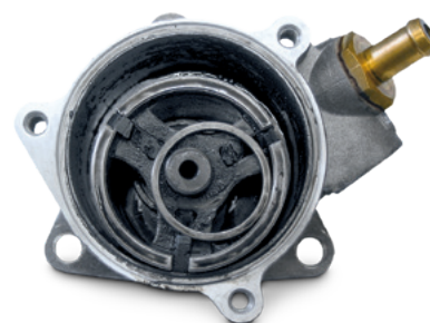
Lubrificazione insufficiente a causa di olio motore sporco e vecchio.
